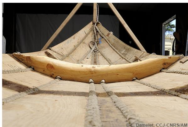
*Varangue en pin d'Alep sur le navire construit dans le cadre du projet d'archéologie expérimentale « Protis ».*
